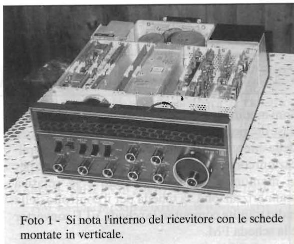
Foto 1 - Si nota l'interno del ricevitore con le schede montate in verticale.
